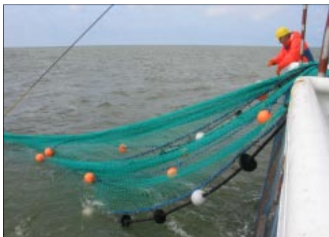
Fot. 1. Badania włoka o oczkach obróconych o 90° Mod 35/31-T90 na r.v. BALTICA we wrześniu 2010 r.
